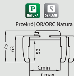
wymagana wysokość otworu w murze 2073 mm (2079 mm dla drzwi szklanych)
